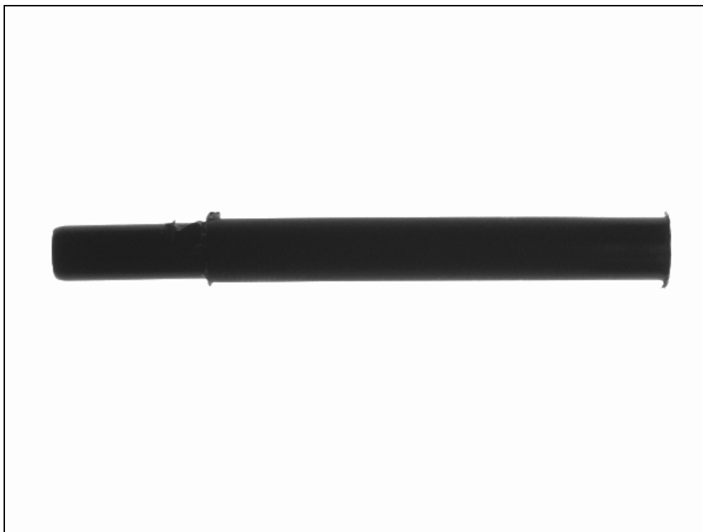
Obr.7: Obrazová banka – vzorek NOK, pohled zboku (zadní osvětlení)
